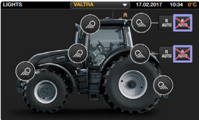
Configuración sencilla de las luces de trabajo desde la terminal. Interruptor de encendido / apagado de luces de trabajo en el apoyabrazos con interruptor de encendido / apagado de balizas.
