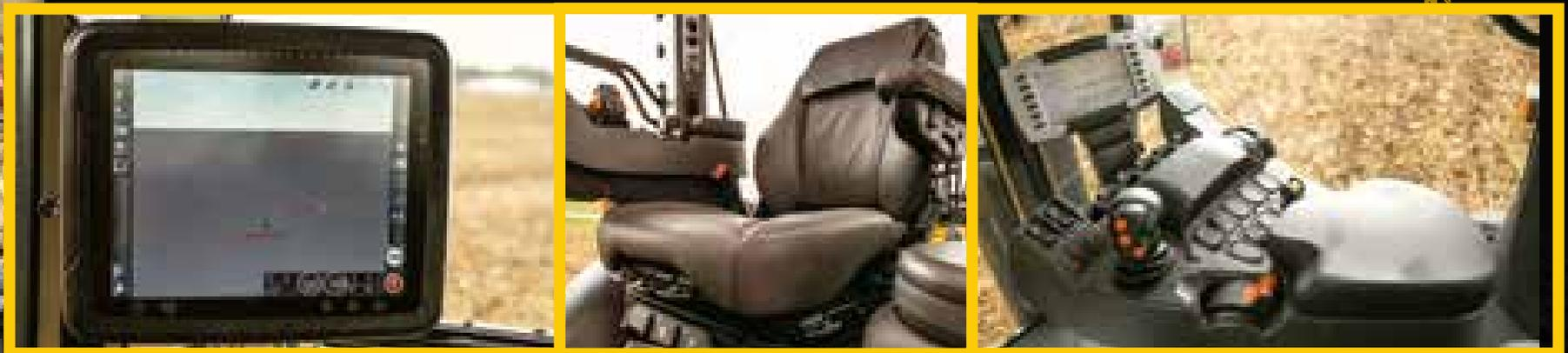
*El sistema Auto Guide 3000 Advanced ofrece máxima eficiencia en el campo, con dirección asistida satelitalmente, con pantalla táctil opcional para una superior facilidad de uso.*
