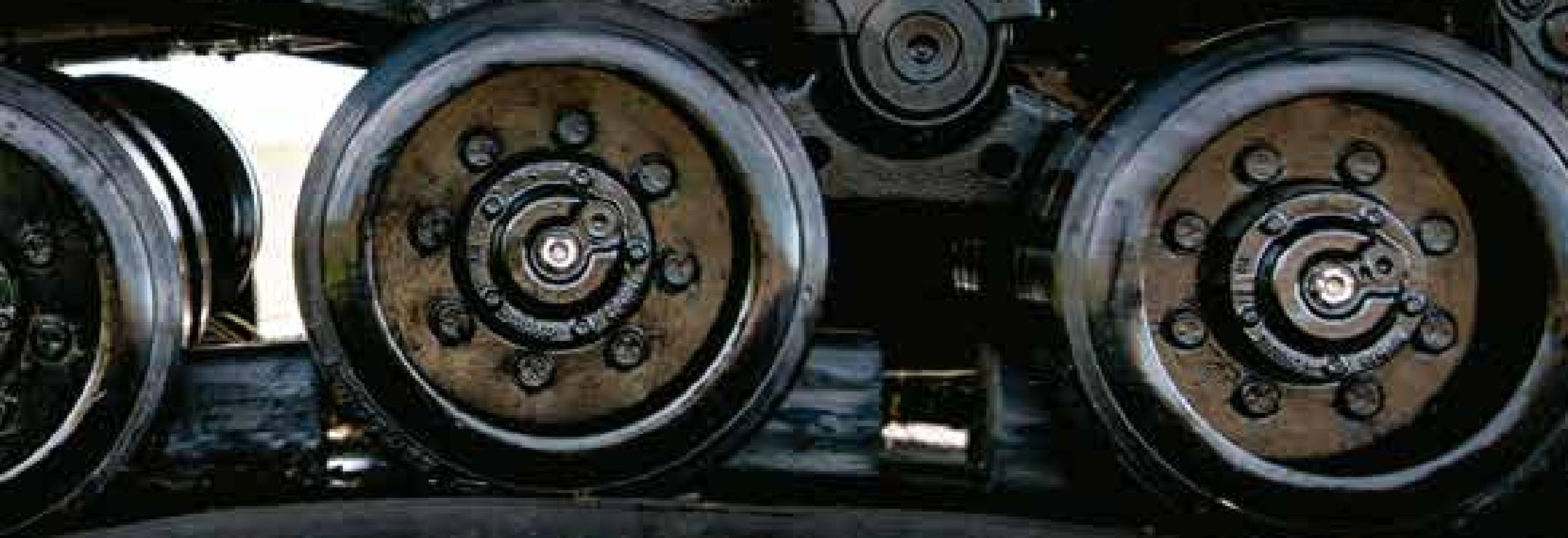
Pero aquí hay mucho más en juego que simplemente potencia bruta. El confort resulta fundamental cuando se trata de un largo día de trabajo en el campo. El sistema Mobil-trac proporciona el andar más confortable gracias al sistema de resortes *MarshMellow* que se comprimen y expanden permitiendo que la barra torsión oscile con libertad. Esta reducción de vibración proporciona una conducción mucho más cómoda que los sistemas de suspensión por air-bag de la competencia.
